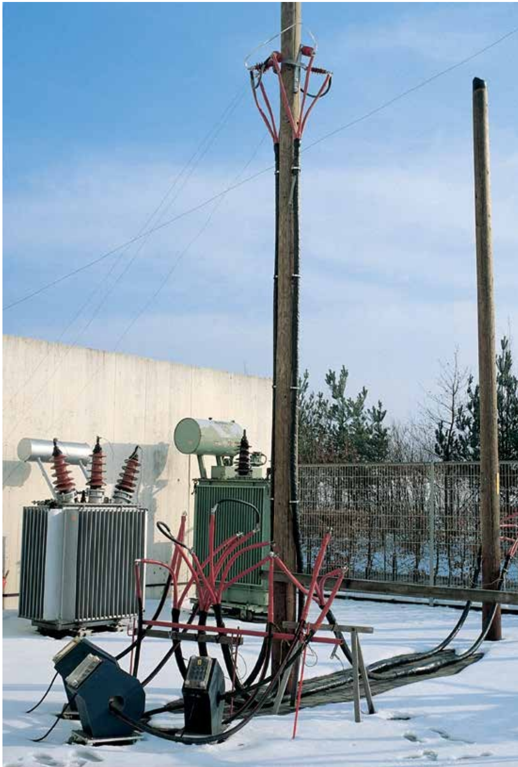
Довгострокові багаторічні випробування муфт GUST і GUSJ на кабелях із паперовою ізоляцією в лабораторіях дослідницького центру Тусо Electronics Raychem GmbH, Оттобрунн, Німеччина.
