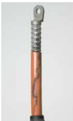
Зразок, пошкоджений трекінговою доріжкою
