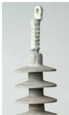
Зразок, пошкоджений ерозією
