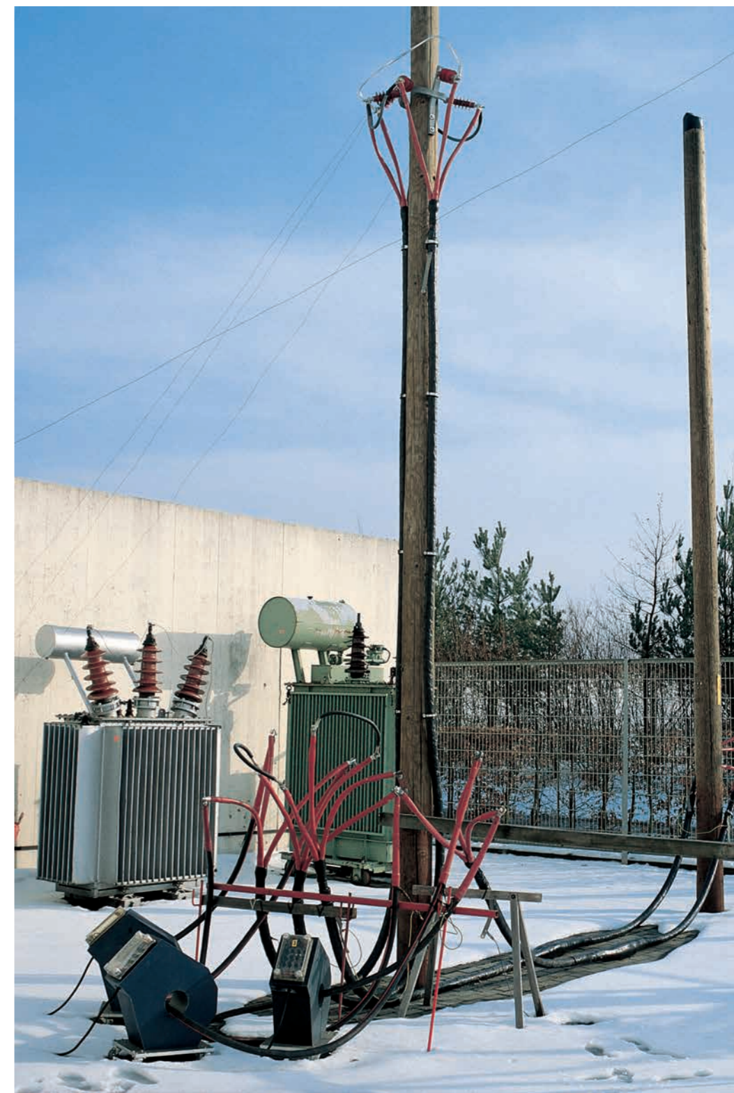
Долгосрочные испытания муфт GUST и GUSJ на кабелях с бумажной изоляцией в лабораториях исследовательского центра TE Connectivity.
