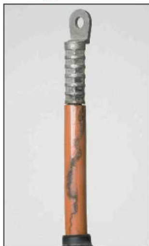
Образец, подвергнутый воздействию влаги и напряжения.
