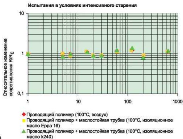
долгосрочные испытания маслостойкого барьера
