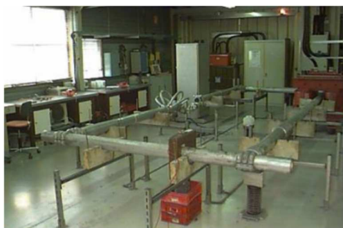
Испытания на нагрев, до 10 кА
