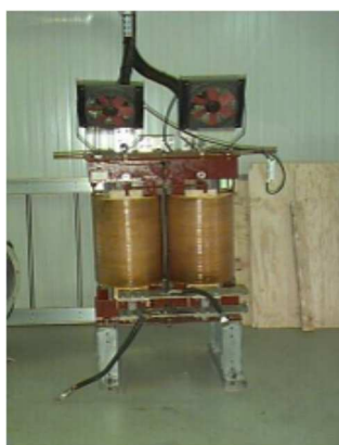
Испытания Токами КЗ, до 42 кА/2сек
