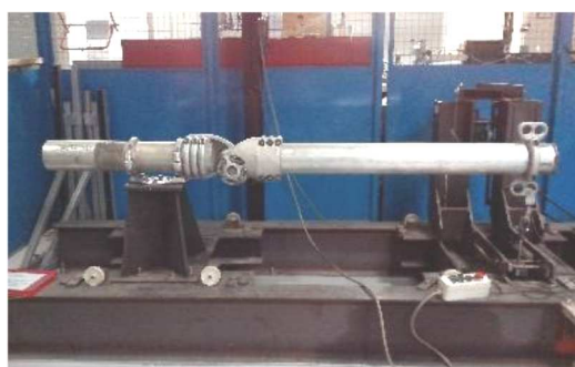
Испытания на изгиб, до 5т/ось
