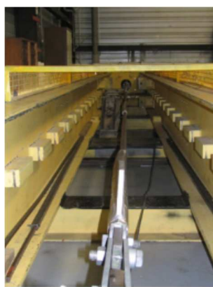
Испытания на механическую прочность, до 70 т
